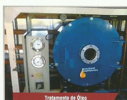
Tratamento de Óleo Isolante com Termovácuo.
